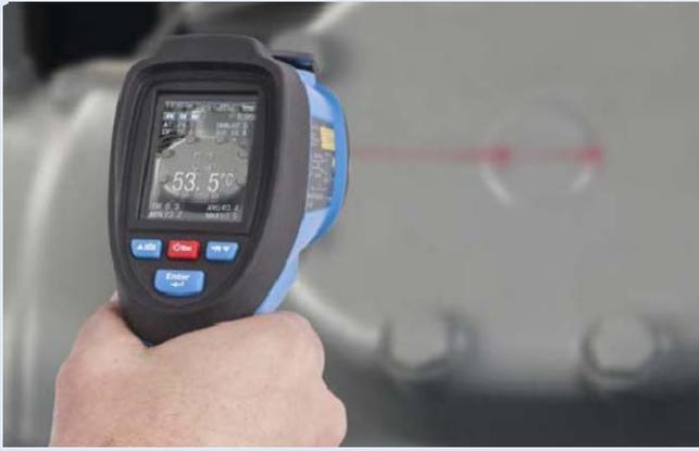
在非接觸量測模式下，測溫儀透過紅外線偵測器偵測物體表面輻射的熱能。將紅外線測溫儀指向目標物體，紅外線偵測器會收集能量並產生訊號，紅外線偵測器即會持續量測物體溫度。可提供快速精確的即時讀數。
